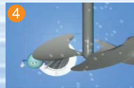
4 凝集剤を混ぜる混和池だ。プロペラにぶつからないように。
