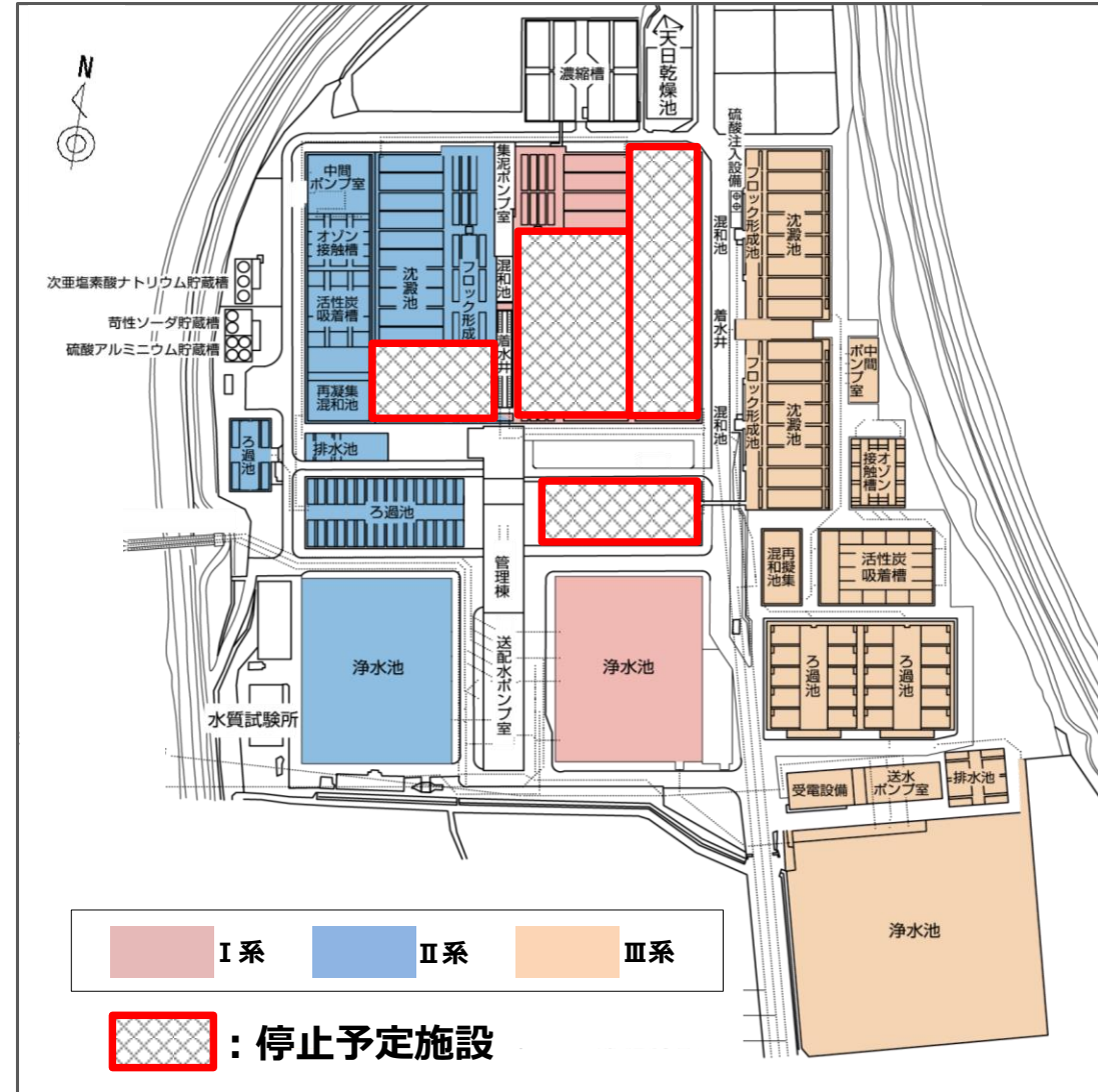
施設規模の適正化に伴う停止予定施設 (猪名川浄水場)
