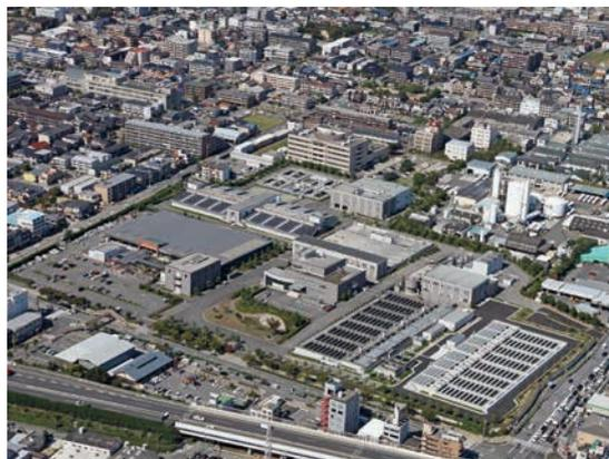
尼崎浄水場は創設事業において整備され、昭和17年度に稼働した。その後、経年劣化及び阪神淡路大震災による被災のため、第5期拡張事業において旧甲山浄水場(施設能力：160,000㎡/日)と統合のうえ全面更新し、平成13年度に半量を、平成22年度に全量を供用開始した。
